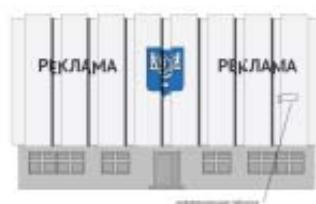
**2.2.3. Видеоэкран - односторонняя рекламная конструкция, размещаемая на плоскости стен зданий, строений и сооружений, состоящая из элементов крепления, каркаса и информационного поля. Рекламная конструкция предполагает демонстрацию рекламы на динамических системах смены изображений (дисплей, монитор, телевизор). Размер информационного поля не должен превышать 30% от площади плоскости фасада (без учета площади окон), на котором он расположен.**
