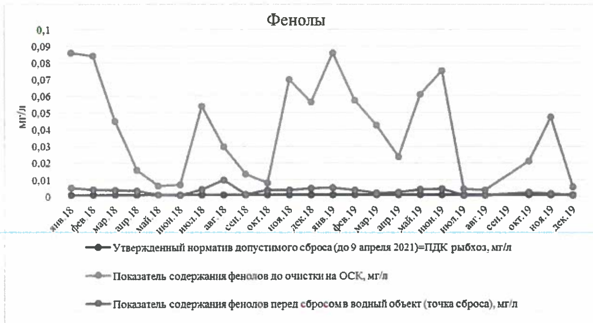
Рисунок 1.7.8. График изменения содержания в воде фенолов
