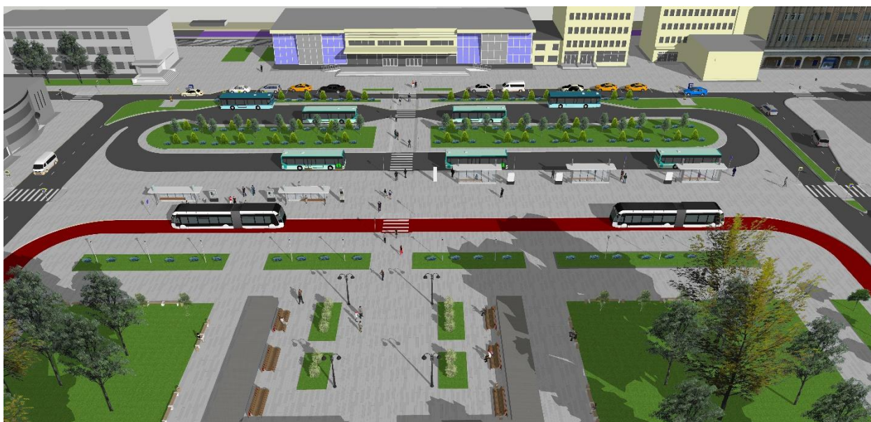
Рисунок 15 – Концептуальное решение организации движения на привокзальной площади с учетом планируемого разворотного кольца скоростного общественного транспорта на привокзальной площади г. Южно-Сахалинска
